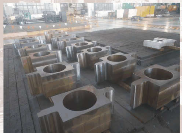
准备进行精加工的工作辊轴承座 Work roll chocks for finish Machining
