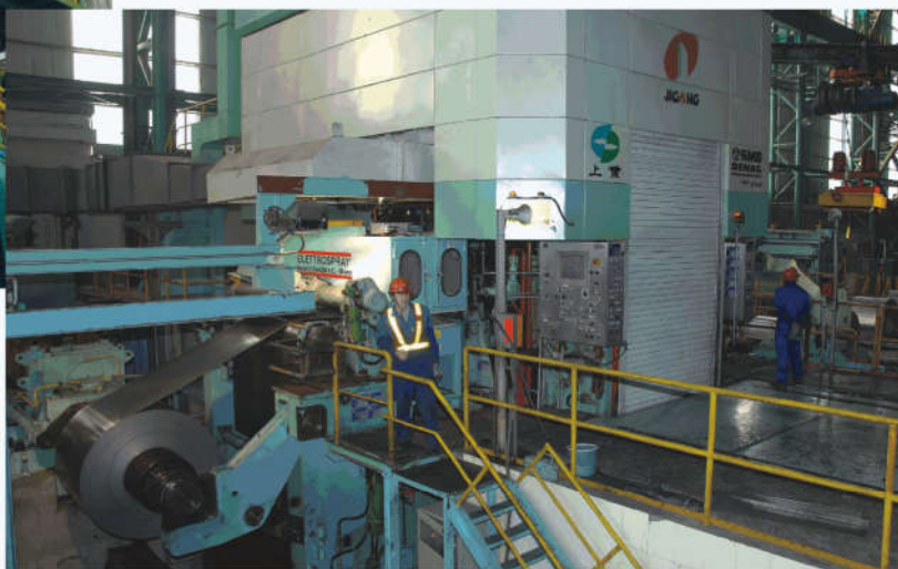
为济钢制造的1700mm冷轧平整机组 1700mm skin pass mill of cold mill for Jigang
