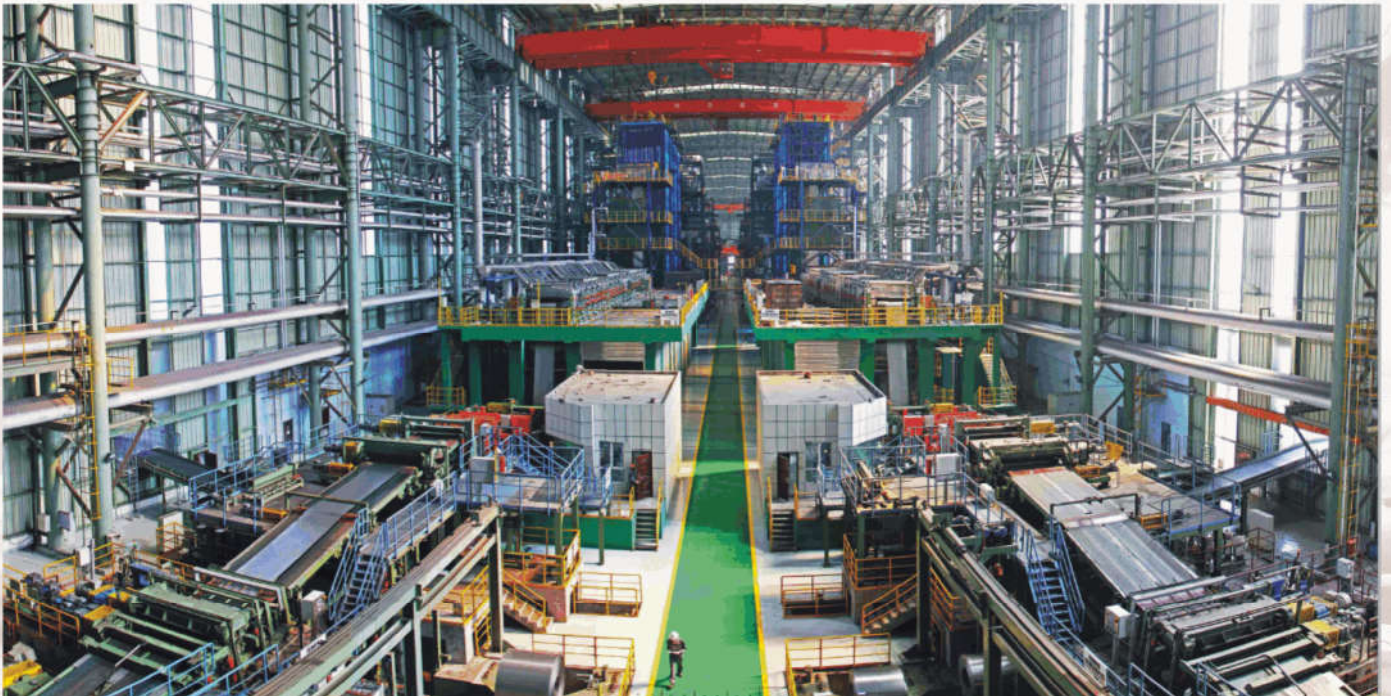
为攀钢西昌制造的2030mm连续退火机组（1#、2#） 2030mm continuous annealing line(1#/2#)for Xichang Pzhsteel
