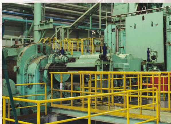
转鼓式飞剪 Drum shear
