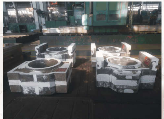
准备进行粗加工的支承辊轴承座 Back-up roll chocks for rough Machining
