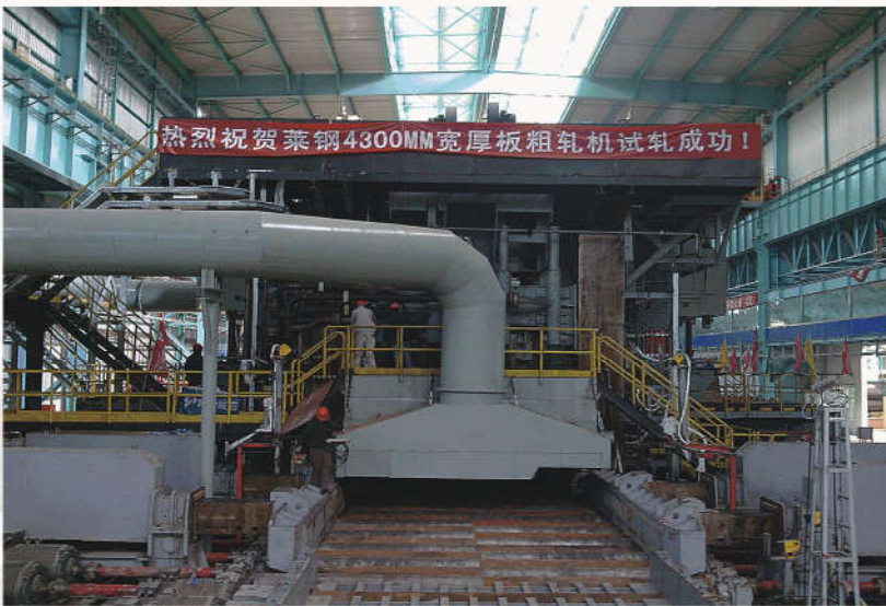
为莱钢制造的4300mm宽厚板粗轧机 (含立辊轧机) 4300mm heavy plate roughing mill (incl. edger) for Laigang Group
