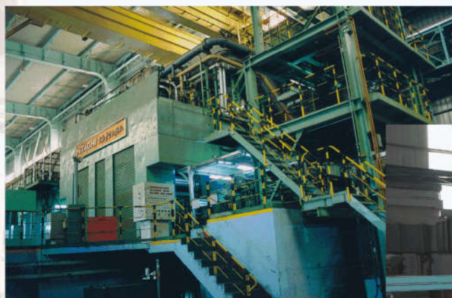
为宝钢制造的1420mm连续退火机组平整机。 1420mm skin pass mill of CAL for Baosteel in 1990s
