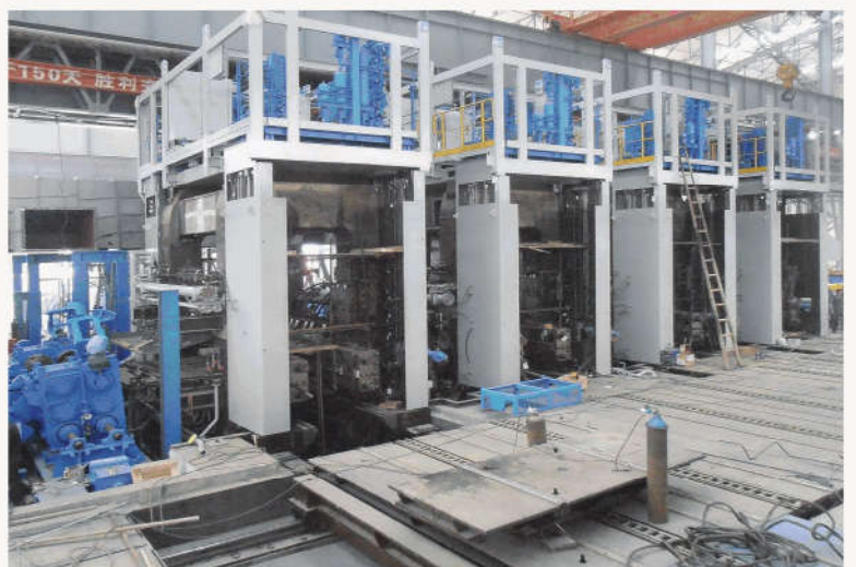
为河南中孚实业公司制造的2560mm“1+4”铝板带热轧机组在用户现场安装(左图为粗轧, 右图为精轧)。 2560mm“1+4”aluminum plate hot rolling line for Zhongfu industrial, assembly at site.,(left:roughing mill/Right:Finishing mill)
