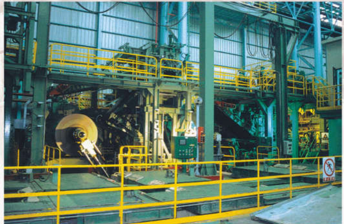
为宝钢制造的1550mm连续退火机组——卷取机 Tention reel 1550mm Continuous annealing line for Baosteel
