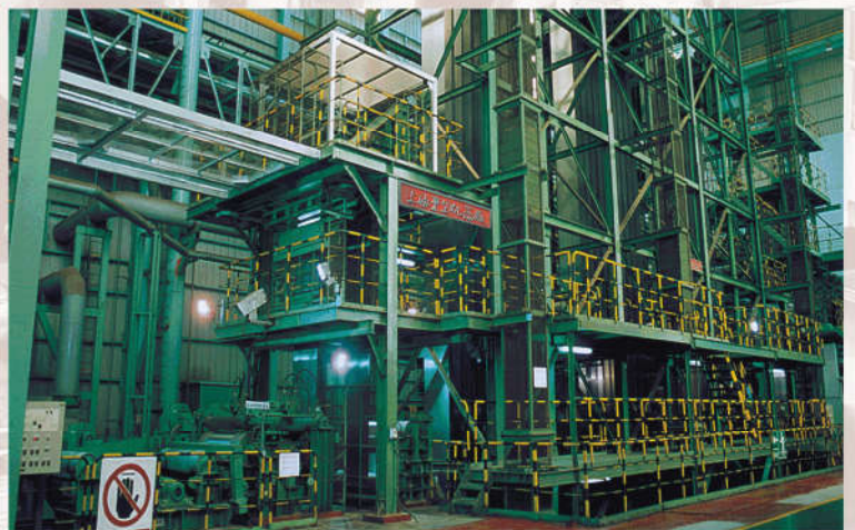
为宝钢制造的1420mm连续退火机组 1420mm continuous annealing line for Baosteel
