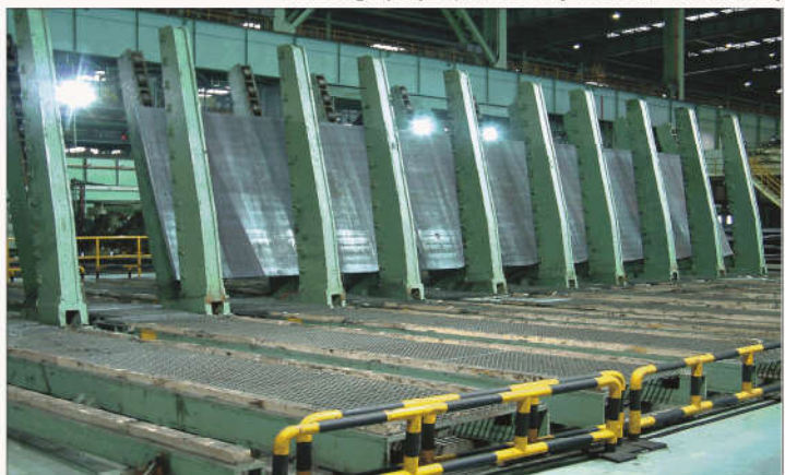
为鞍钢鲅鱼圈分公司 自行设计制造的5500mm宽厚板翻板机 self-designed plate turnover of 5500mm heavy plate mill for Bayuquan Ansteel
