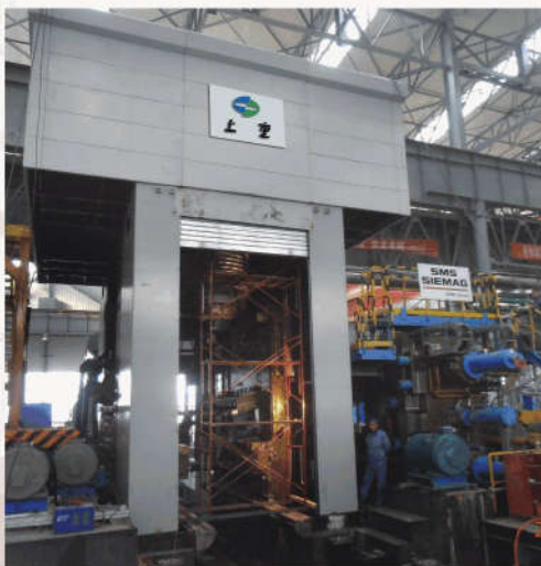
为河南中孚实业公司制造的2560mm“1+4”铝板带热轧机组在用户现场安装(左图为粗轧, 右图为精轧)。 2560mm“1+4”aluminum plate hot rolling line for Zhongfu industrial, assembly at site.,(left:roughing mill/Right:Finishing mill)
